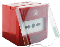
ML-2730.IS Maxlogic Bouton d'alarme incendie conventionnel, réinitialisable, résistant aux intempéries (IP65), sécurité intrinsèque
