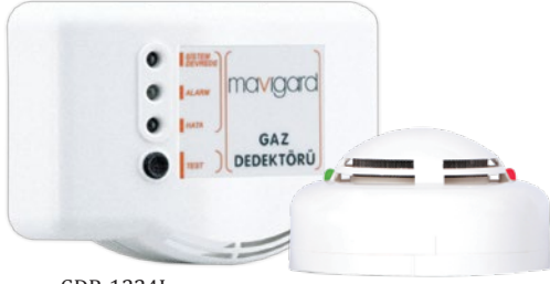
GDR-1224L Mavigard Konvansiyonel LPG (Bütan+Propan) Gaz Dedektörü, Röle Çıkışlı, 12/24V DC
