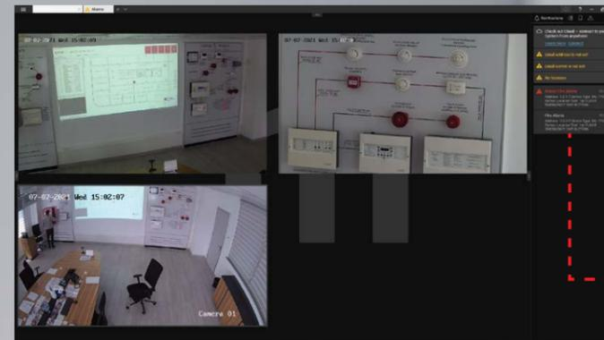
Информация о пожаре отображается в верхней правой части экрана в виде всплывающего окна. Камера или камеры, соответствующие устройству, с которого пришла пожарная тревога, автоматически включатся. Таким образом, информация о пожаре отображается с камер, находящихся в этом районе.
