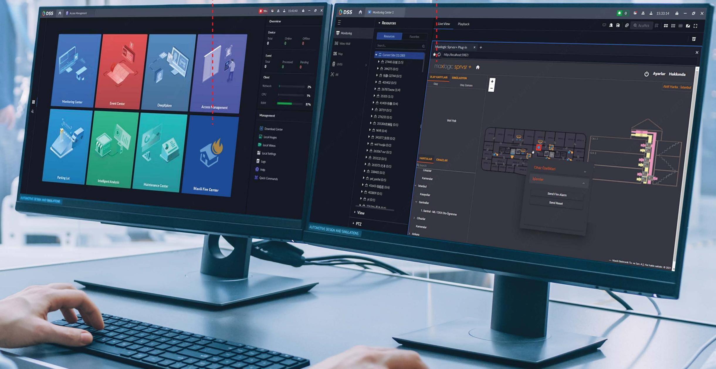
Grâce à cette intégration, toutes les alarmes provenant des systèmes adressables Maxlogic et Mavigard de Mavili peuvent être visualisées en temps réel sur l'interface de **DSS**. Lorsqu'un incendie est détecté, les enregistrements vidéo avant et après l'événement démarrent automatiquement. L'emplacement exact de l'incident est affiché sur la carte et sur le plan de l'étage, et la gestion des caméras, des alarmes et des scénarios peut être effectuée à partir d'une seule plateforme.
