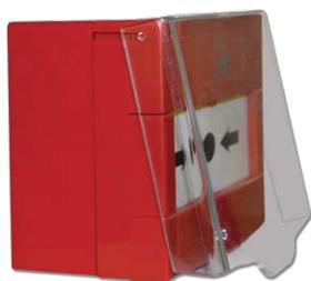
Le bouton est activé en appuyant dessus le rideau en plastique flexible. Le micro-interrupteur, qui repose contre le rideau en plastique, se libère et change de position, et reste dans cette position jusqu'à ce qu'il revienne à la position précédente. Le bouton se réinitialise facilement avec le commutateur de réinitialisation.
