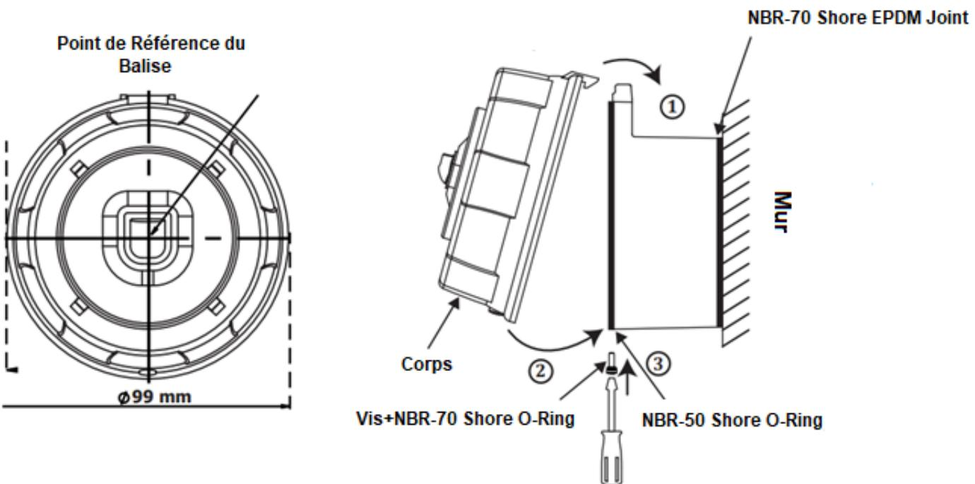
\* Lors de l'installation, il est important d'utiliser un joint NBR EPDM entre le mur et le boîtier, un joint NBR O-Ring entre le boîtier et le boîtier, et un petit joint NBR O-Ring sur la vis, comme indiqué sur le schéma. Sinon, le niveau de protection IP déclaré ne pourra pas être atteint.
